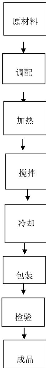
原材料分别由 80mm 管道从储藏罐运送至混合罐顶部的平台上，所有原料在此混合。
